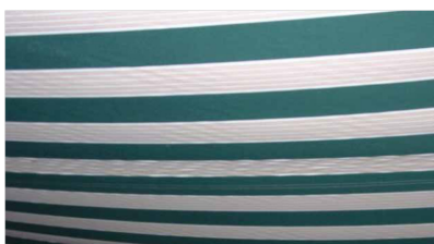
Afbeelding 10: Wafelvorming aan een baan
