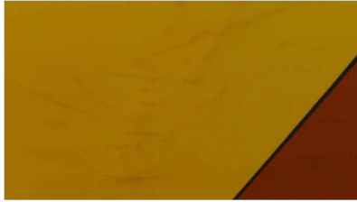
Afbeelding 17: Manipulatievouden bij zonweringdoek uit polyester
