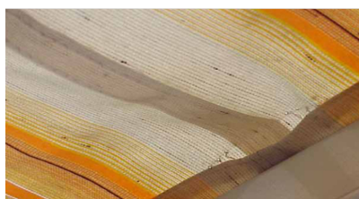
Afbeelding 7: Draadbreek in de onderzoom
