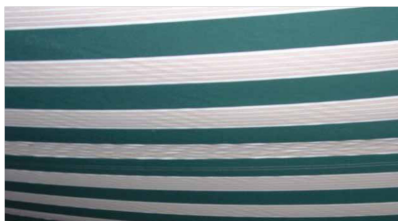
Afbeelding 10: Wafelvorming aan een baan
