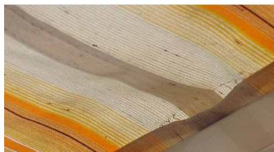
Afbeelding 7: Draadbreek in de onderzoom
