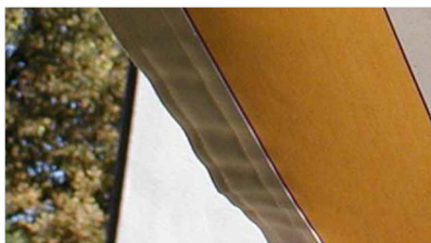
Afbeelding 9: Wafelvorming en uitrekken bij de zoom
